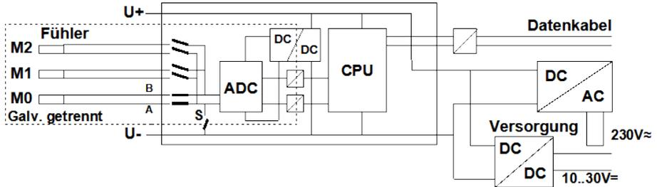
Die analogen Eingänge sind durch photovoltaische Relais untereinander galv. getrennt. Neu bei diesem Gerät ist die zusätzliche Trennung der Messeingänge von CPU und Stromversorgung. Zwischen allen Ein- und Ausgängen (auch den nicht galv. getrennten Analogausgangskabeln) ist ein Potentialunterschied von maximal 50 V zulässig. Die Spannung an den Messeingängen selbst (zwischen B,C,D und A) darf 12V nicht überschreiten!
